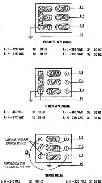
L2, L3 - N - 120 VAC 10 60 HZ L2, L3 - N - 115 VAC 10 50 HZ
