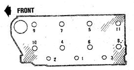
**CYLINDER HEAD BOLT TIGHTENING SEQUENCE**
