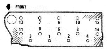
**CYLINDER HEAD BOLT TIGHTENING SEQUENCE**
